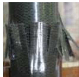
(d) Local buckling failure
