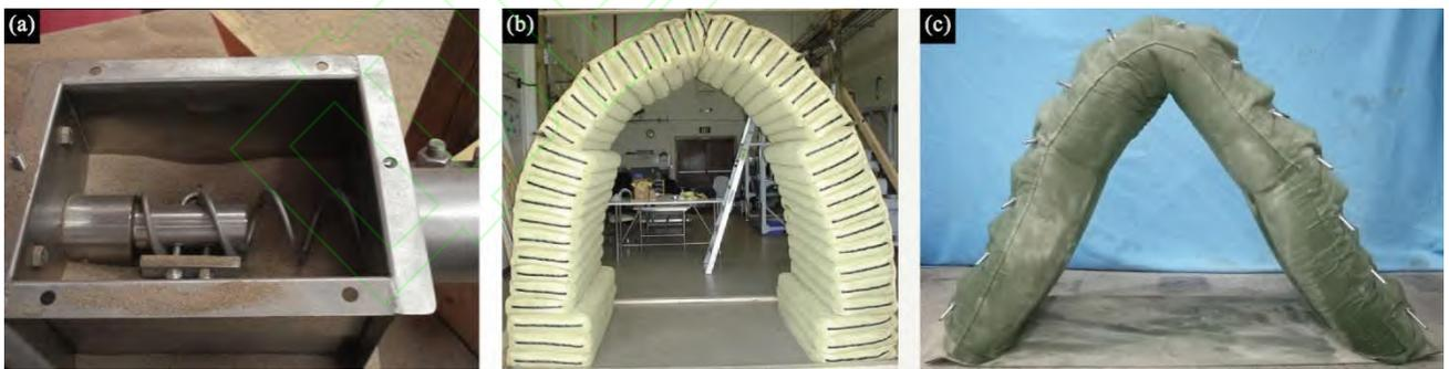
图 9 (a) NASA 月壤袋装填系统<sup>[81]</sup>；(b) NASA 月壤袋试件<sup>[81]</sup>；(c) 笔者的月壤袋试件
