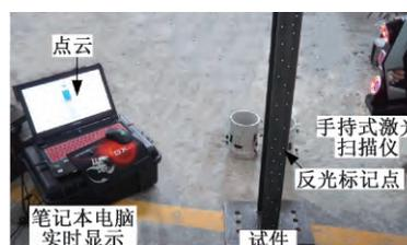
图 8 三维激光扫描设备和扫描钢柱现场<sup>[15]</sup>
